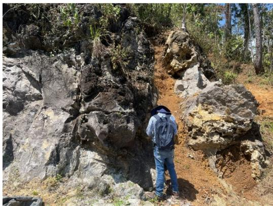
**Figura 1.** Afloramiento de roca caliza y suelo residual arcilloso de color amarillo.
