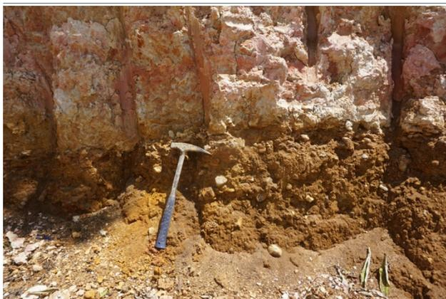
**Figura 37.** Gravitas con cantos de cuarzo y líticos de terraza (T3), en contacto con depósitos piroclásticos con alto desarrollo de arcilla blancas a rojizas.
