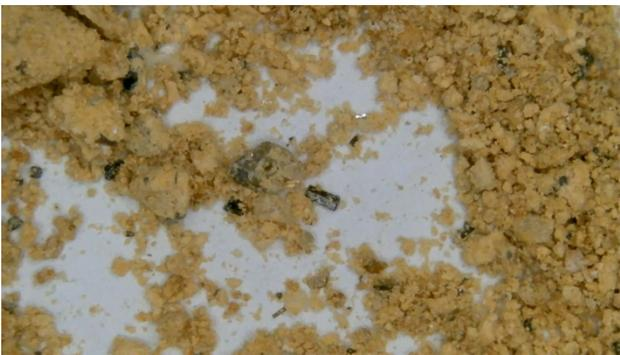
**Figura 3.** Fracción fina de depósitos piroclásticos de caída, conteniendo partículas de pumita, láminas de mica (biotita), cristales de anfíbol de color negro.
