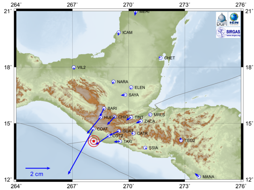
Figura 5: Estaciones GNSS (GPS+GLONASS) de operación continua, donde se indica el código de estación y un vector proporcional al desplazamiento horizontal del terreno estimado. Fuente: www.sirgas.org
